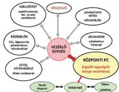
A PC-hez csatolt vezérlőegységgel ellátott klímavezérlés baromfitartó istállók részére
