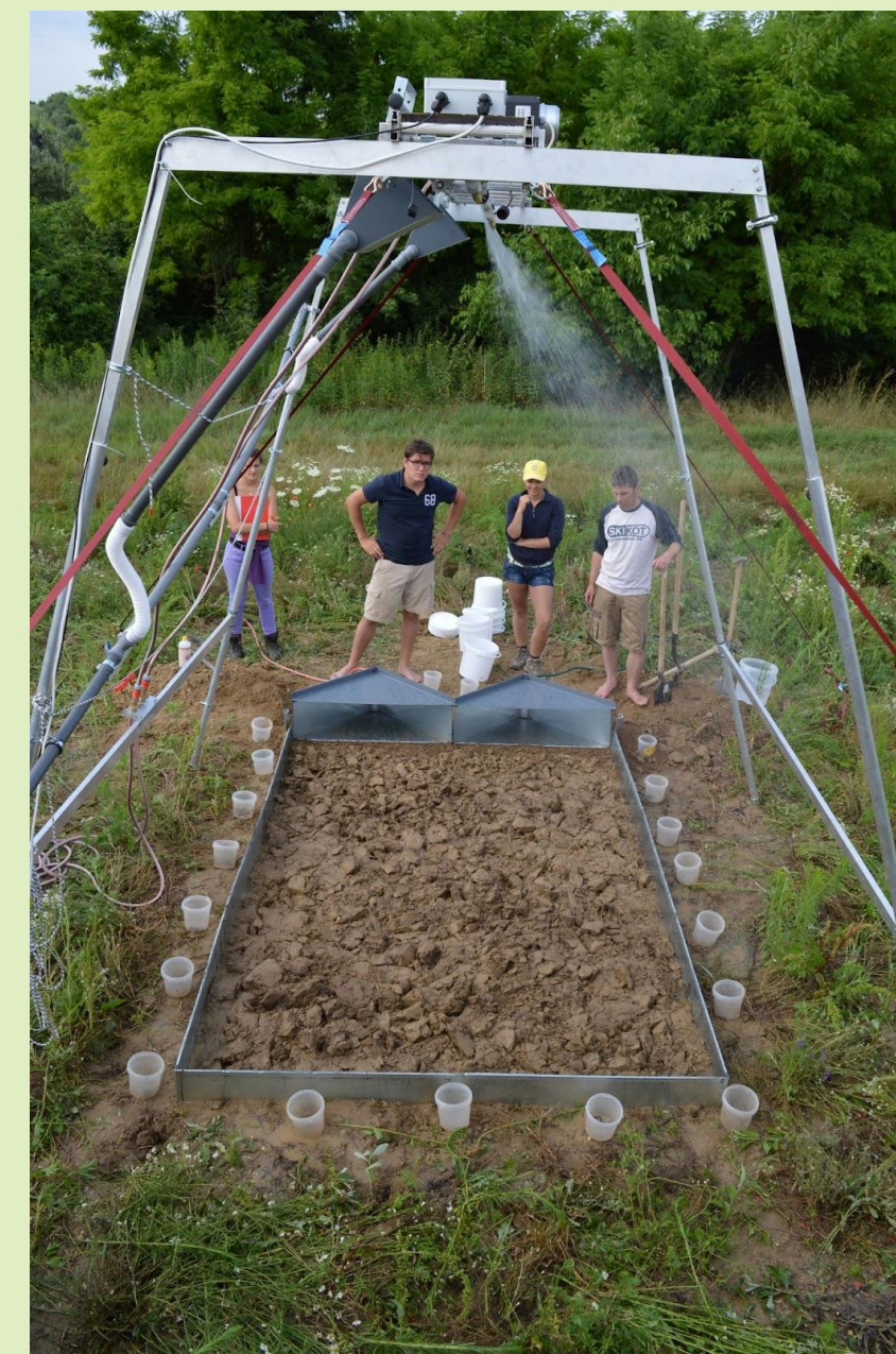
1-2. kép: SP02 parcella szintű esőztető berendezés üzemelés közben a lehatárolt parcellával, körben mérőedényekkel, melyek a csapadék eloszlásához nyújtanak információt. A parcella alján 2 db háromszög formájú vízelvezető és azok kifolyói. A kifolyóknál mérőhengerek, illetve mintagyűjtő edények.
