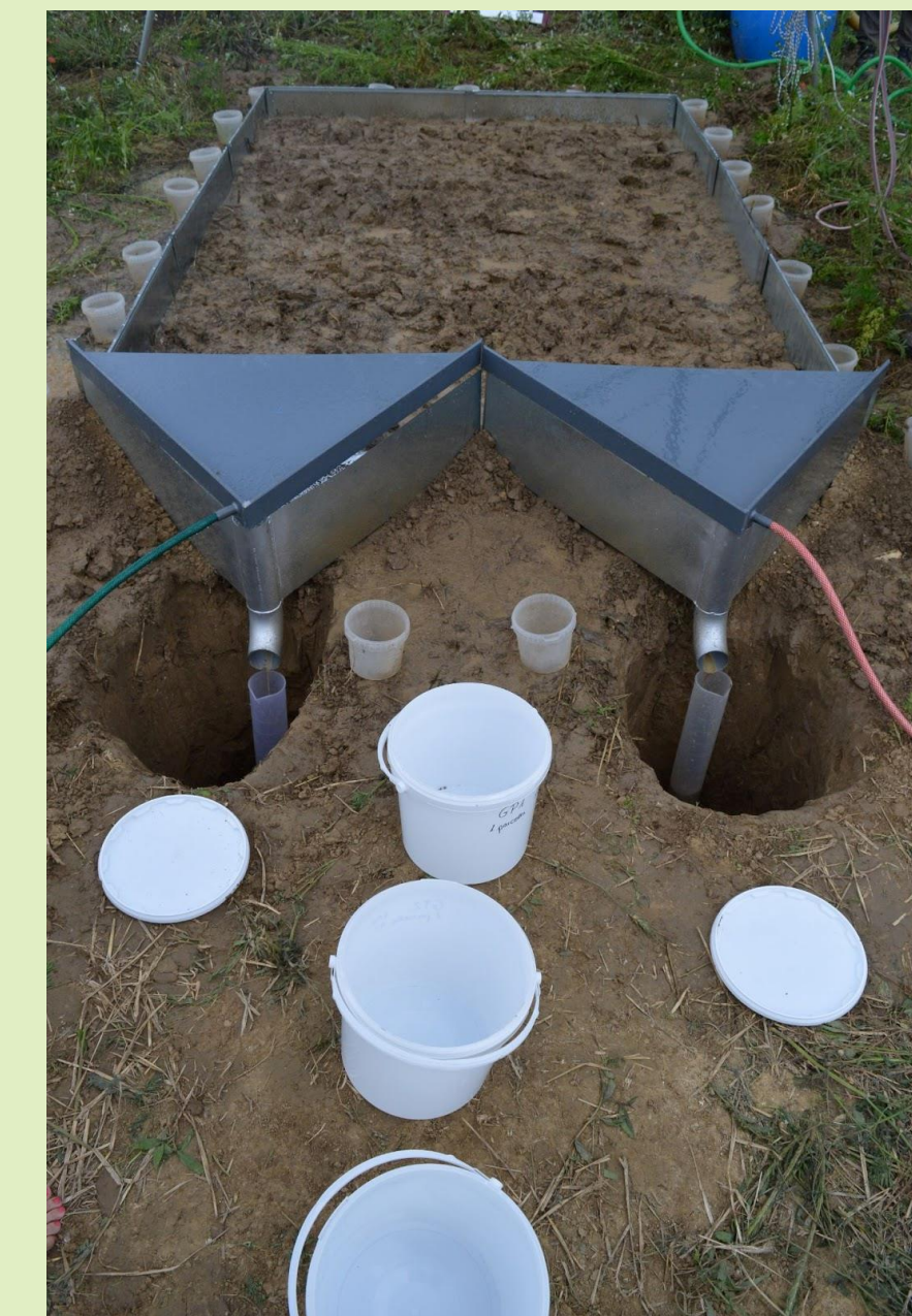
1-2. kép: SP02 parcella szintű esőztető berendezés üzemelés közben a lehatárolt parcellával, körben mérőedényekkel, melyek a csapadék eloszlásához nyújtanak információt. A parcella alján 2 db háromszög formájú vízelvezető és azok kifolyói. A kifolyóknál mérőhengerek, illetve mintagyűjtő edények.
